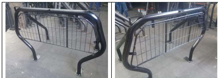
Malla cubre luneta instalada en la barra exterior
