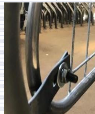
Deformación de la fijación .
