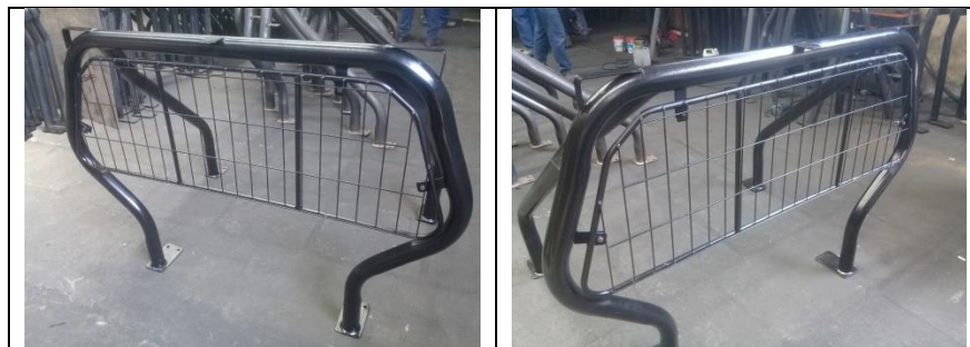
Malla cubre luneta instalada en la barra exterior
